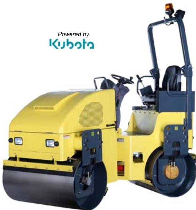
Verrouillage de sécurité pour prévenir des accidents . L'opérateur doit être dans le siège pour que le moteur démarre.
