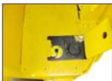
Accès facile au bouchon du réservoir de gasoil situé sur le plancher
