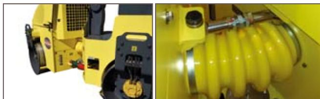
Double articulation avec points de graissage 'Pac-pivot' (brevet)
