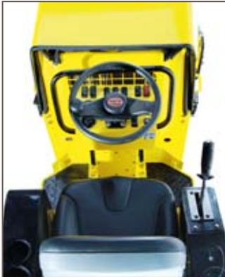
Siège ergonomique antivibratile avec contacteur de sécurité
