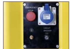
Boîte de commande avec prise de courant de 230 volts.
