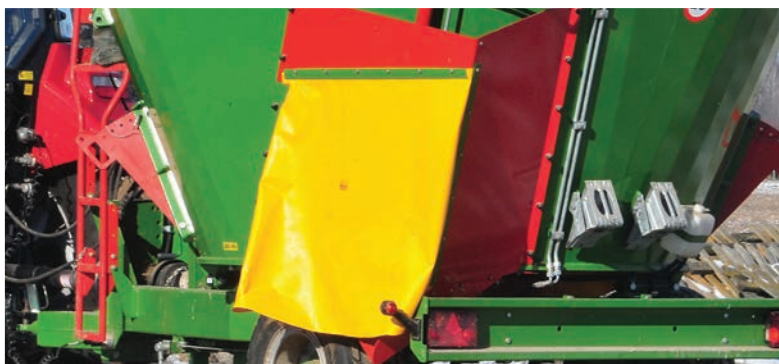
VMP-10S – fenêtres de déchargement avec gouttières et couvertures
