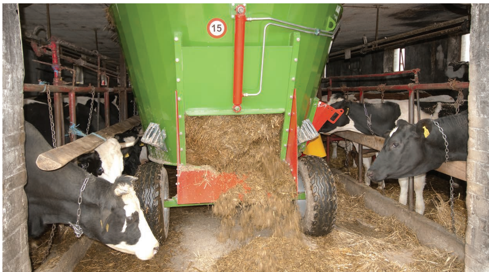
PRONAR VMP-5ST – deux fenêtres de dosage avec gouttières : fenêtre latérale à l'avant à droite et fenêtre à l'arrière (sur le photo)
