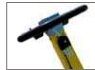
Poignée anti-vibrations protégée par des supports en caoutchouc et servo-contrôle.
