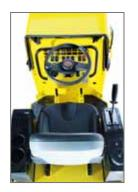
Siège ergonomique antivibratile avec contacteur de sécurité
