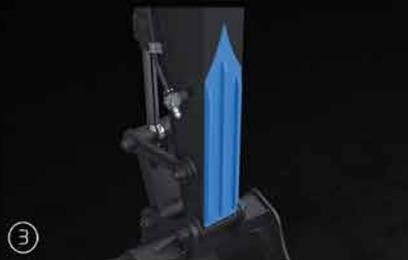
③ Pièces d'appui de balancier renforcées
