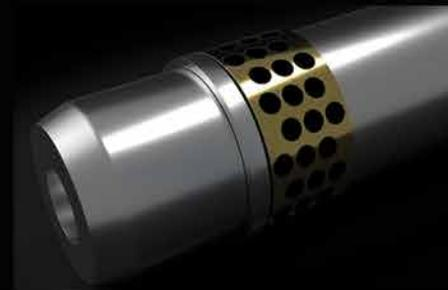
Les bagues en bronze graphité utilisées aux points de connexion flèche-balancier et flèche-châssis diminuent la fréquence des interventions de lubrification et empêchent efficacement l'usure des axes grâce au graphite intégré dans la structure interne des bagues. Ce matériau possède une très grande capacité d'absorption et de rétention de la graisse.
