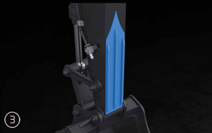
③ Pièces d'appui de balancier renforcées
