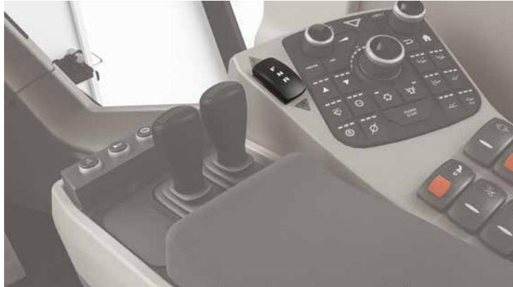
La fonction (**TIPSHIFT**) offre une facilité d'utilisation à l'opérateur. Il est possible de changer de direction rapidement en appuyant sur une seule touche sans utiliser le levier de vitesses lorsque la machine avance ou recule tout en chargeant ou en déchargeant. Cela augmente la productivité et garantit un fonctionnement sûr sans perte de contrôle de la direction.
