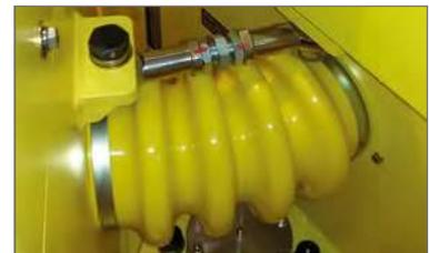
Double articulation avec points de graissage 'Pac-pivot' (breveté)
