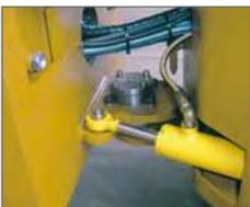
Articulation de pivot unique avec point de graissage
