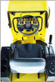
Siège ergonomique antivibratile avec contacteur de sécurité
