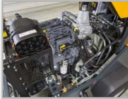
Le moteur Diesel compact et robuste satisfait à toutes les exigences de la norme des émissions en vigueur « Stage V » dans l'UE et en Suisse.
