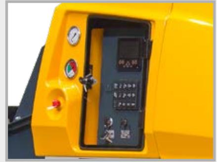
Pavé de commande central avec clavier intuitif selon le principe « Suivre l'éclairage bleu » – commande simple et fiable, parfaitement protégée grâce à la robuste porte en plexiglas.
